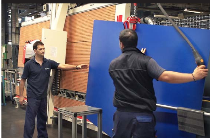
Schont den Rücken: eine Platten-Hebehilfe im Daimler-Werk Gaggenau
