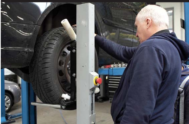
Entlastung: Reifen-Hebehilfe im Volkswagen-Autohaus Neu Isenburg
